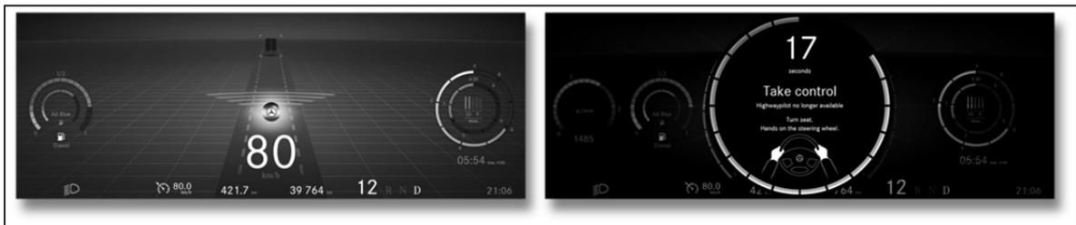
Bild 1: Instrumentoberfläche im Highway Pilot Modus und Aufforderung zur Übernahme
