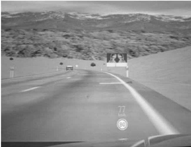
Bild 15: Anzeige einer notwendigen Querführungskorrektur im kHUD (Lange, 2008).
