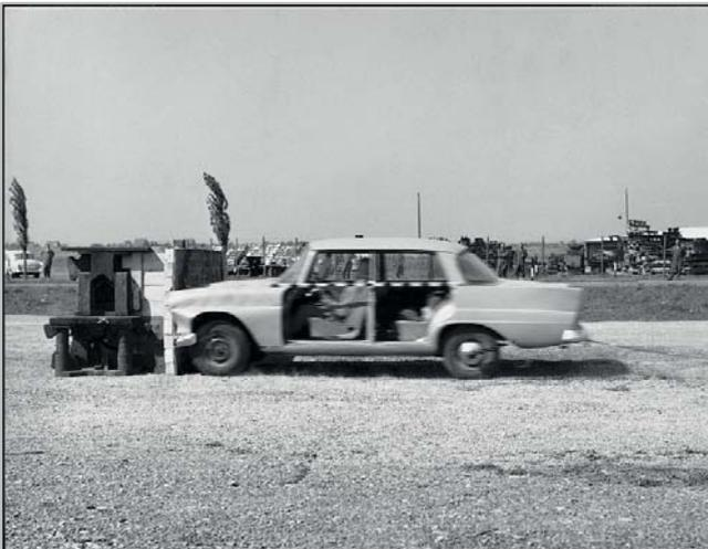
Bild 1: Erster Crashtest (Frontalkollision gegen stehendes Hindernis) bei Mercedes-Benz im Jahre 1959 (Daimler, 2009).
