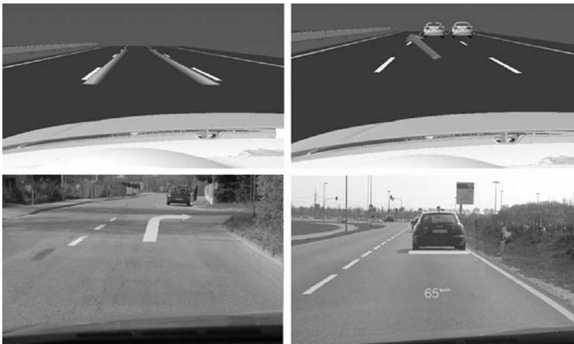
Bild 16: Weiter mögliche Anzeigekonzepte für Spurhaltung, Ausweichempfehlung bei Kollisionswarnung, Navigation und Sicherheitsabstand (Israel & Bubb, 2010).
