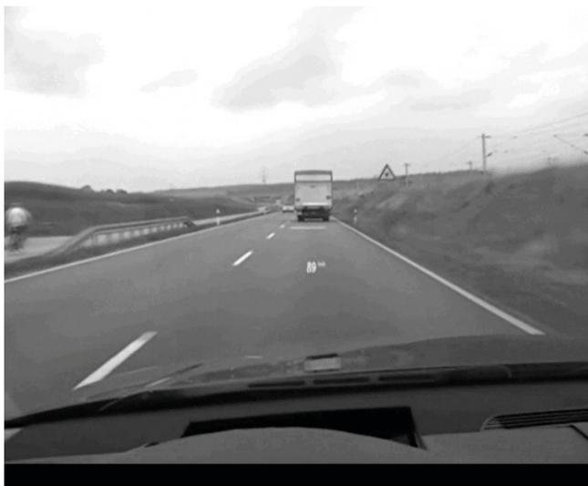
Bild 14: Kontaktanaloges HUD (kHUD) mit Abstandsbalken (Prototyp Audi).
