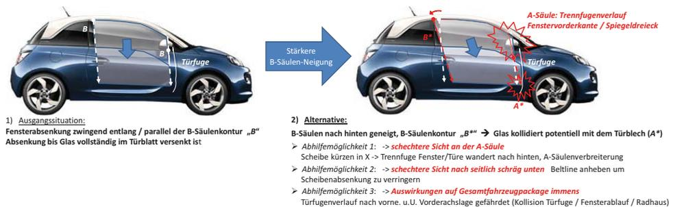
Bild 2: Wechselwirkung des B-Säulenparameter „Neigungswinkel“, „Scheibenablauf“ und „Sicht a der A-Säule“ / „Sicht über die Beltline“.
