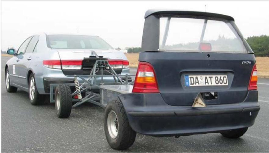
Bild 3: EVITA bestehend aus Zugfahrzeug und Anhänger (Hoffmann, 2008, S. 22).
