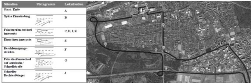
Bild 6: Situationsgehalt und -lokalisierung der Beurteilungsszenarien in der Versuchsstrecke in Rüsselsheim.
