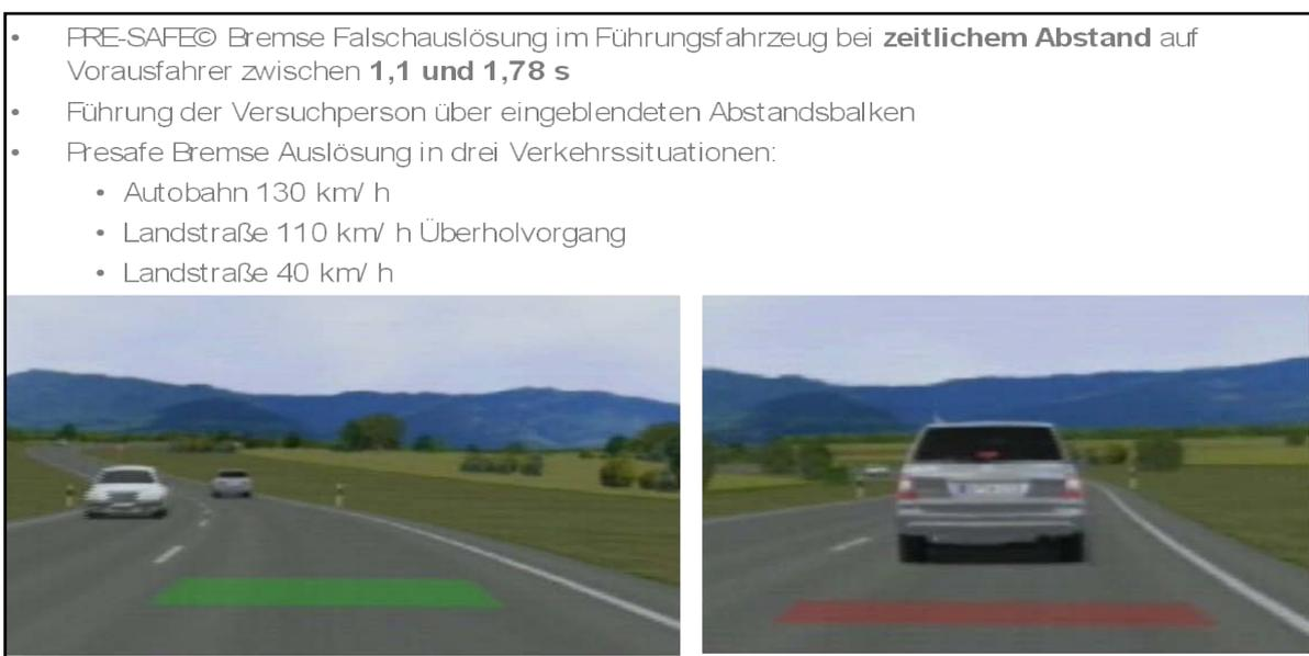
Bild 6: Fahrsimulatorversuch zur Beherrschbarkeit von PRE-SAFE-Bremse Falscheingriffen mit Vollverzögerung
