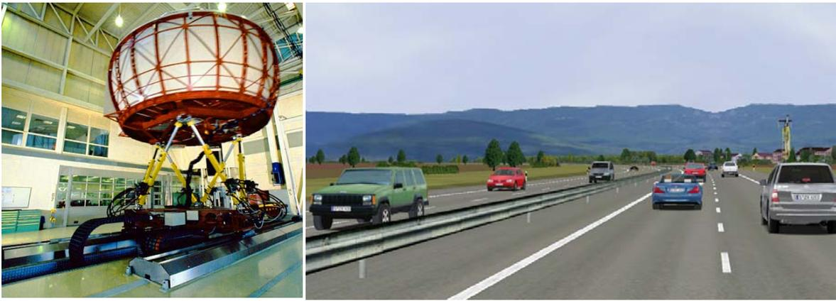
Bild 3: Mercedes-Benz Fahrsimulator in Berlin
