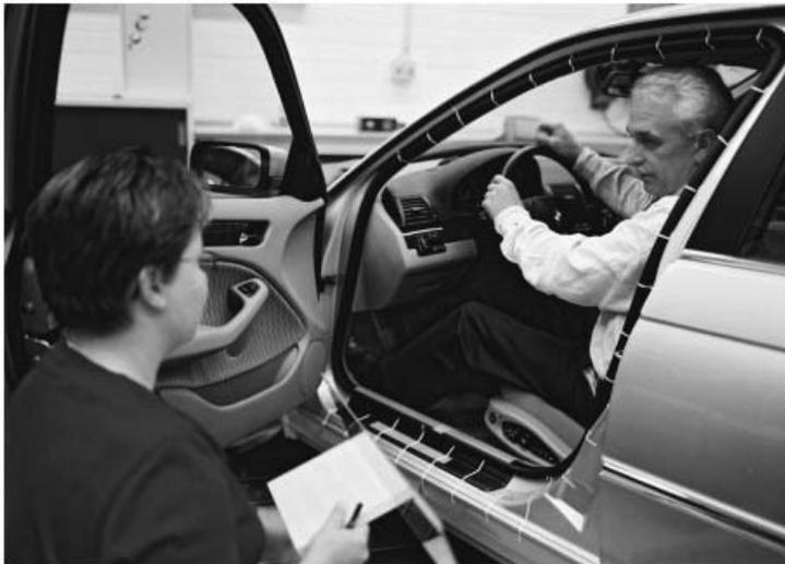
Bild 2: Standbeurteilung am realen Fahrzeug zur Ergonomie-Absicherung.
