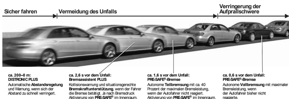
Bild 3: Radarbasierte Assistenzfunktionen zur Vermeidung bzw. Milderung eines Auffahrunfalls
