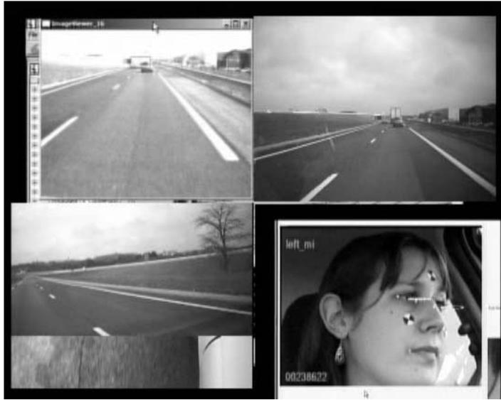
Bild 1: Videobild der Versuchsfahrt – Bild der Stereo-Head-Kameras mit lokalisiertem Ziel (oben links); Straßenabschnitt vor dem Fahrzeug (oben rechts); Straßenabschnitt hinter dem Versuchsfahrzeug (unten links – oberes Bild); Blick vom linken Außenspiegel nach unten auf die Fahrspur (unten links – unteres Bild); Gesicht des Probanden (unten rechts)
