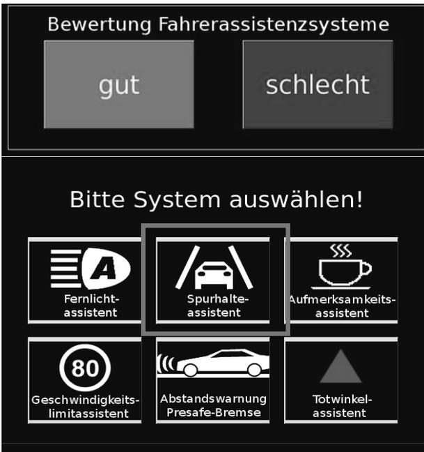
Bild 2: Beispiel für eine Oberfläche zur Bewertung des Systemverhaltens über ein Touchpad-Display. Der Fahrer kann jederzeit (unabhängig von einer erfolgten Systemauslösung) eine Bewertung vornehmen und so auch fehlende Systemauslösungen dokumentieren
