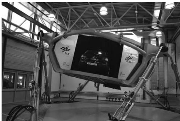
Bild 4: Der dynamische Fahrsimulator.
