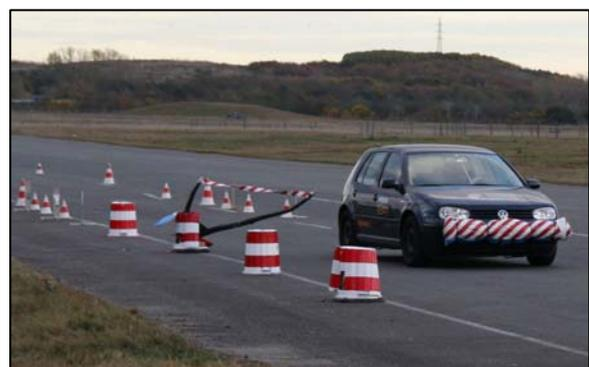
Bild 4: Eingesetztes Hindernis: Gummischlauch, der sich aus einem Eimer entfaltet
