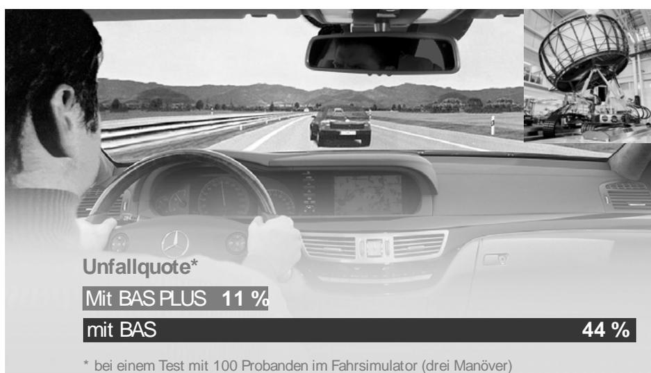
Bild 8: Unfallquoten mit BAS PLUS im Fahr Simulatorversuch
