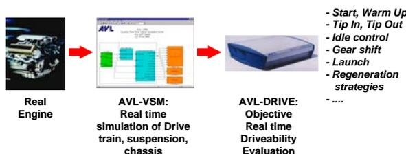
Abb. 23: Entwicklungsaktivitäten am Prüfstand mit Motor und ECU vorhanden
