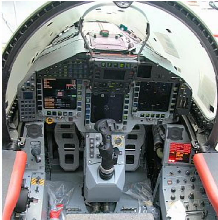
Bild 2: Eurofighter Cockpit. Zu sehen ist das in der Mitte installierte Head Up Display mit Combiner und drei Multifunction Head Down Displays. Auf dem Display unterhalb des Combiners werden Triebwerksparameter und Parameter der Kommunikationseinrichtungen des Flugzeuges angezeigt. Auf der rechten Seitenkonsole befindet sich das Warning Panel.
