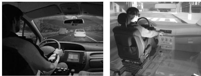
Bild 2: Fahrsimulator mit realer (links) und virtueller Fahrzeugrepräsentation (rechts) am Fraunhofer IAO
